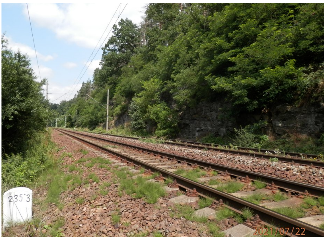
Obr. 5 Zvětralá pararula ve svahu odřezu u koleje č. 2 v km cca 235,300-400
